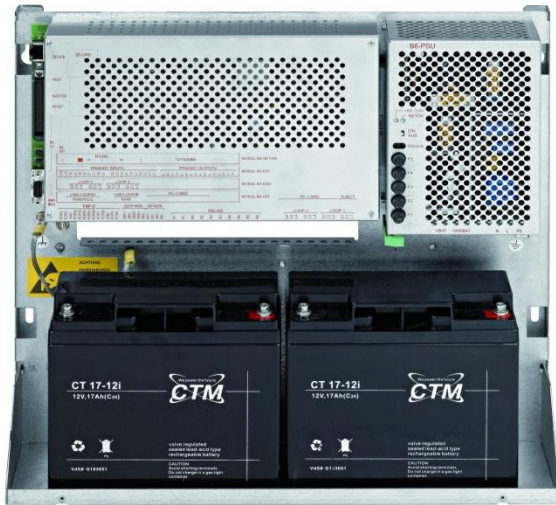
Suporte traseiro com CPU, fonte e bateria
